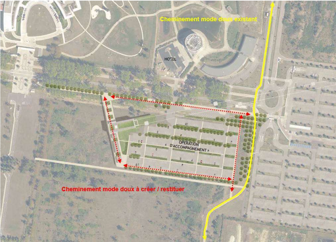
Figure 25 : Schéma de principe des liaisons modes doux et VP au niveau de la future station d'Oncopole (source : Groupement POMA, 2018)
